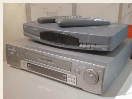
Jako źródło sygnału wzorcowego wykorzystaliśmy materiał nagrany na taśmie SVHS, którą odtwarzaliśmy w magnetowidzie Thomson SCENIUM VSH 2080G. Antenę satelitarną podłączyliśmy do tunera Pace MSS288-G.
